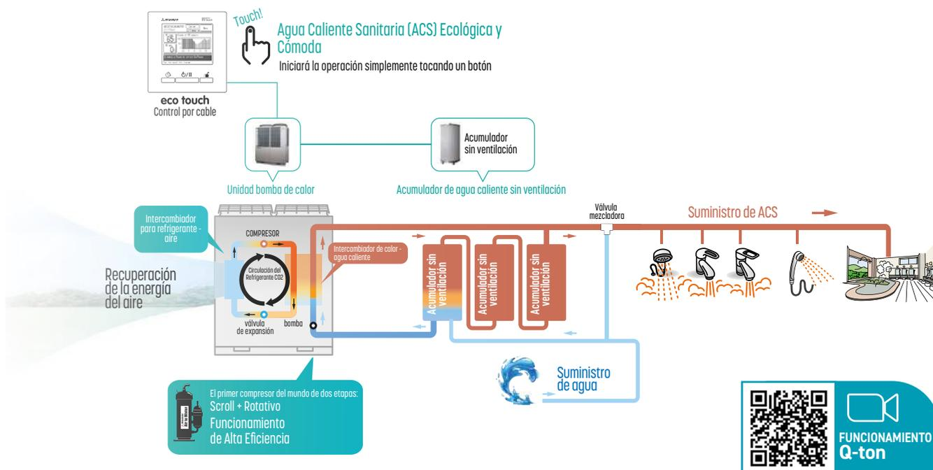
1. La unidad exterior captura la energía calorífica del aire exterior (fuente de calor) incrementa su temperatura a través del compresor mediante el proceso de compresión.
