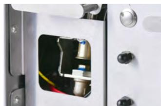
**Generador de chispa alimentado a 230 V**
